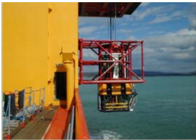
Троллейная система запуска и возврата ТПА, Subsea 7, Великобритания
