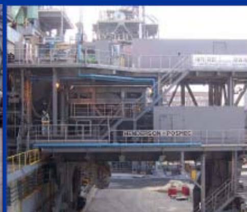
Коксовыталкиватель, «ПОСКО», Корея
