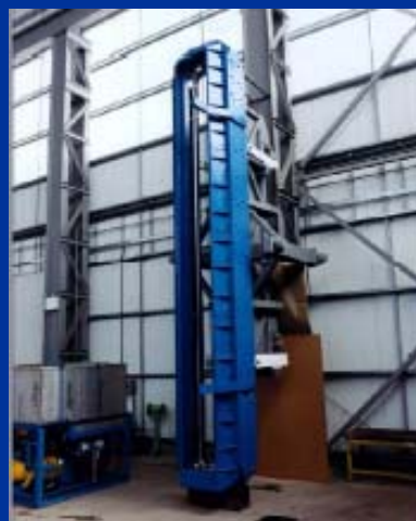
Водоструйный очиститель дверей, CST, Бразилия
