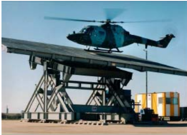
Имитационная модель посадочной площадки вертолета,
