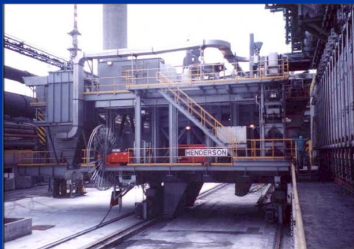
Коксовыталькиватель, Lucchini, Италия
